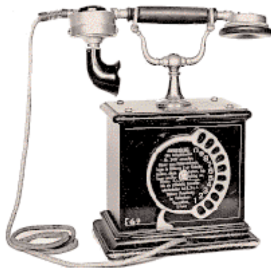
Στα πρώτα αυτόματα μοντέλα του 1915 οι δίσκοι έχουν ημικυκλική μορφή.
