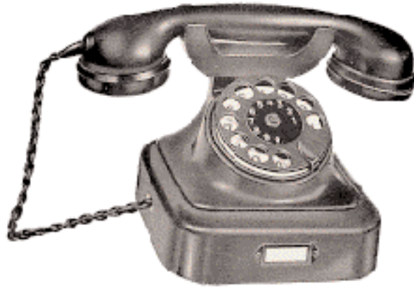
Το 1936 εμφανίζεται η κλασική συσκευή με κέλυφος από βακελίτη.
